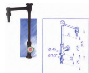
Chandelier Anti-aspiration à 1 robinet EN proposé en 4 versions: - Modèle Fixe - Rejet 150 mm à Embout Démontable diamètre 10 mm - Modèles Orientables à Embout Démontable diamètre 10 mm, Rejet 150 mm, 200 mm ou 250 mm. Robinets en laiton revêtu de Pyroflex Noir, revêtement résistant aux projections corrosives. Diamètre G=1/2". Serrage 55 mm.
