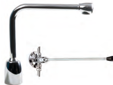
Mitigeur à Commande « Fémorale » Mitigeur à bec lisse « Fixe » ou « Orientable » Hauteur sous bec 200 mm Saillie 200 mm Flexible SPEX M10 x 1, EP G3/8, longueur 350 mm Aérateur étoile M24 x 1 Commande fémorale de Longueur 390 mm au totale (340 mm de commande directe)
