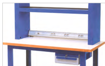
Réhausse à Etagère Réglable Réalisée en Tôle pliée 12/10 ème, l'étagère est revêtue de caoutchouc strié. Etagère réglable selon 3 de profondeur 400 mm.
