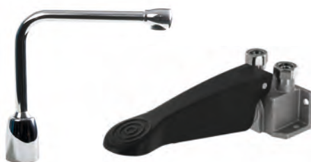
Mitigeur à Commande « au Pied » Mitigeur à bec lisse « Fixe » ou « Orientable » Hauteur sous bec 200 mm Saillie 200 mm Flexible SPEX M10 x 1, EP G3/8, longueur 350 mm Aérateur étoile M24 x 1 Pédale simple Arrivée mâle G 1/2» (15 x 21) en eau froide, chaude ou pré-mitigée
