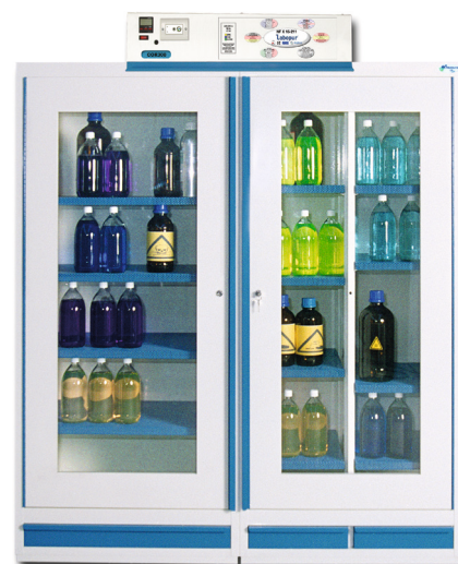
Modèle "AF 4-3" Enceinte Double dont une des armoires est Compartimentée Dimensions extérieures : 1900 x 1600 x 545 mm poids 290 Kg Dimensions intérieures : 1500 x 780 x 500 mm 4 Etagères + 1500 x 380/380 x 500 mm 8 Demi-étagères Capacité de stockage 260 L
