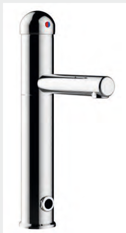
Mitigeur à Commande « Infra Rouge Secteur » Mitigeur à bec lisse Hauteur sous bec 200 mm (* autre sur études) Saillie 150, 200 ou 250 mm Flexible SPEX M10 x 1, EP G3/8, longueur 650 mm Aérateur étoile M24 x 1 Tête sphérique Alimentation Secteur
