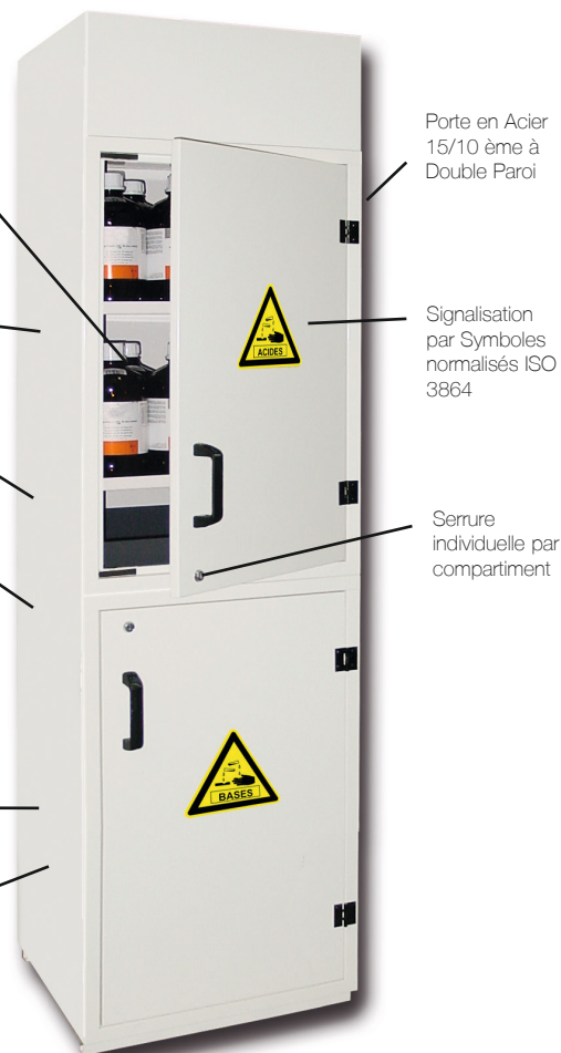
Armoire Verticale à 2 Compartiments distincts - AMS 675 "Acides/ Bases" Ventilateur Intégré dans le Caisson Haut...
