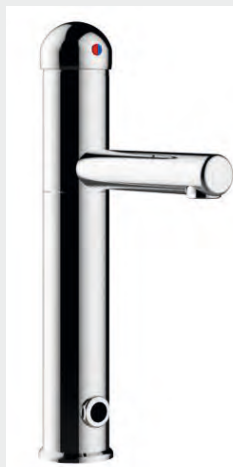
Mitigeur à Commande « Infra Rouge Secteur » Mitigeur à bec lisse Hauteur sous bec 200 mm (* autre sur études) Saillie 150, 200 ou 250 mm Flexible SPEX M10 x 1, EP G3/8, longueur 650 mm Aérateur étoile M24 x 1 Tête sphérique Alimentation Secteur
