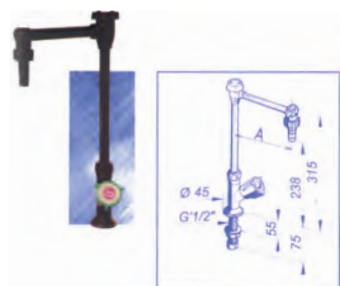
Chandelier Anti-aspiration à 1 robinet EN proposé en 4 versions: - Modèle Fixe - Rejet 150 mm à Embout Démontable diamètre 10 mm - Modèles Orientables à Embout Démontable diamètre 10 mm, Rejet 150 mm, 200 mm ou 250 mm. Robinets en laiton revêtu de Pyroflex Noir, revêtement résistant aux projections corrosives. Diamètre G=1/2". Serrage 55 mm.
