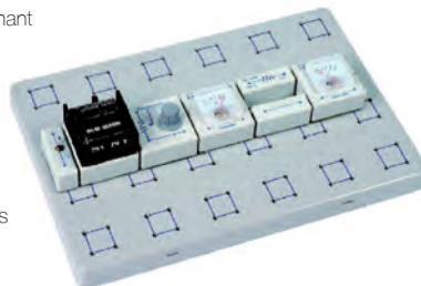
Montage de démonstration de la loi d'Ohm : U = R.I
