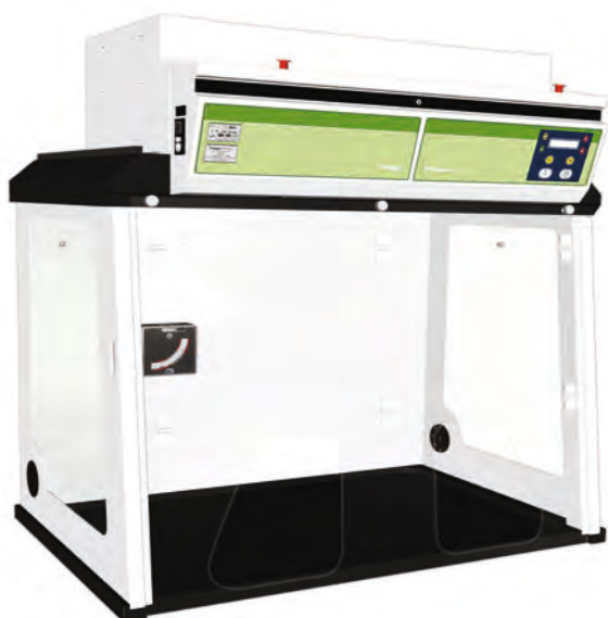
Hotte Captair Flex - Modèles EVS 8391 Dimensions extérieures : 1000 x 620 x 1146 mm Dimensions intérieures : 965 x 540 x 890 mm (Un Modèle plus profond peut être proposé sur devis) Complète avec bac de rétention, plan de travail en verre
