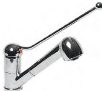
Mitigeur Douchette à Commande « Coude » Mitigeur à bec lisse orientable Douchette sur Flexible Extractible Hauteur sous bec 126 mm Saillie 210 mm Flexible SPEX M10 x 1, EP G3/8, longueur 350 mm Aérateur étoile M24 x 1
