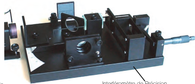
...Interféromètre de Précision HEN 650265 + le Kit d'Accessoires HEN 650266
