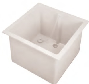
Cuve Vulcathène 460 x 460 mm - Polysinc Profondeur Utile 300 mm. Dimensions Utiles 400 x 400 mm Avec trop plein et Bonde surmoulée Bouchon et Grille sont fournis avec la cuve. Chainette (optionnelle)
