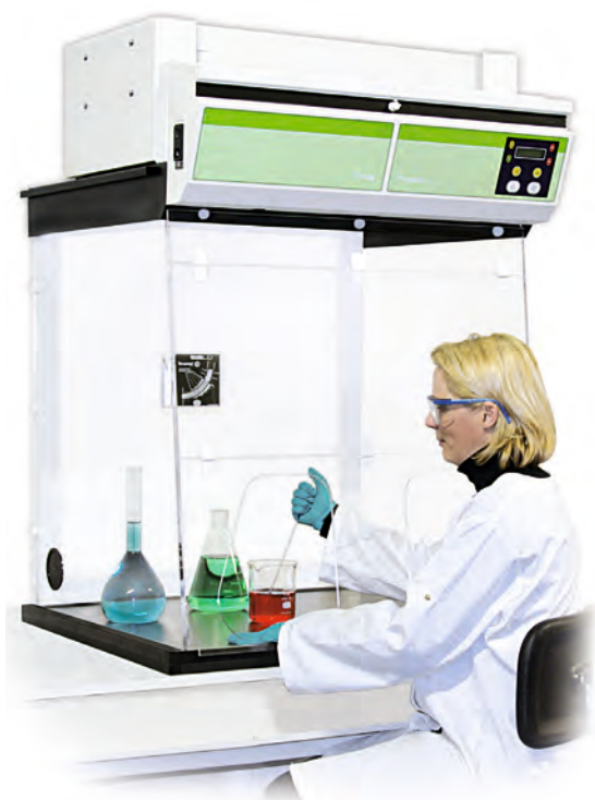
Hotte Captair Flex - Modèles EVS 8321 et 8021 Dimensions extérieures : 800 x 620 x 1146 mm Dimensions intérieures : 764 x 540 x 890 mm Complète avec bac de rétention, plan de travail en verre et paroi arrière transparente C'est le modèle le plus souvent demandé en Lycée.
