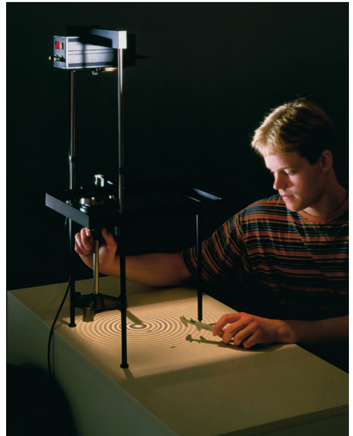
Cuve à Ondes SF 221100 Ensemble complet en coffret selon composition ci-dessous
