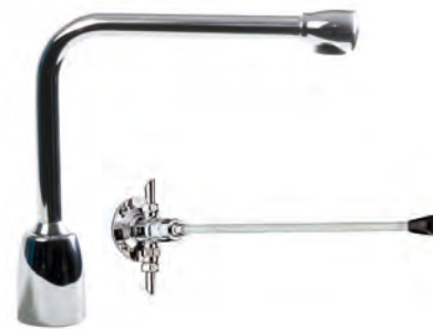
Mitigeur à Commande « Fémorale » Mitigeur à bec lisse « Fixe » ou « Orientable » Hauteur sous bec 200 mm Saillie 200 mm Flexible SPEX M10 x 1, EP G3/8, longueur 350 mm Aérateur étoile M24 x 1 Commande fémorale de Longueur 390 mm au totale (340 mm de commande directe)
